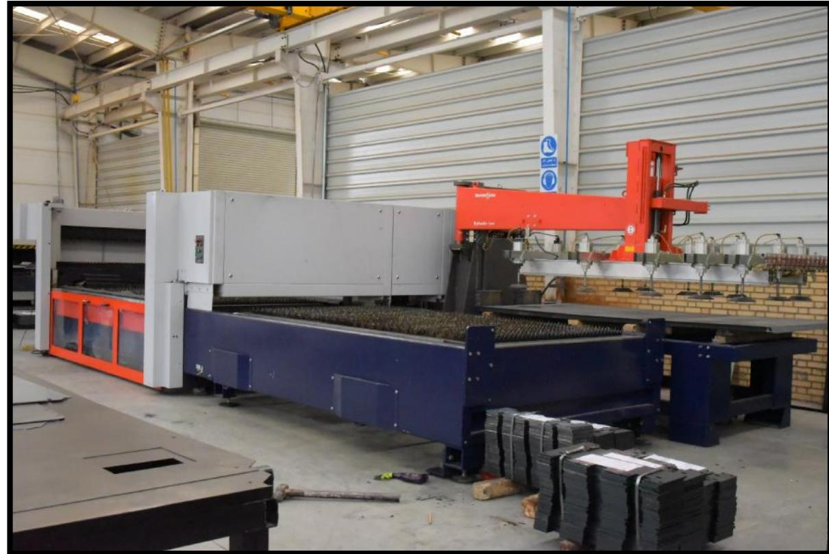
دستگاه لیزر CO2 بیسترونیک سوئیس به قدرت 3kW و ابعاد کارگیر ۱۵۰۰\*۳۰۰۰ میلیمتر و
