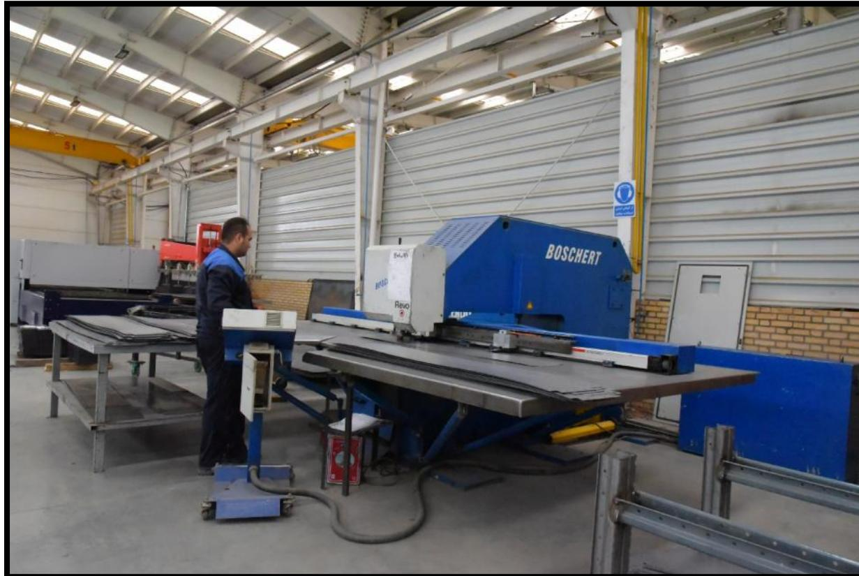
دستگاه پانج CNC بوشرت آلمان به ظرفیت 40KN و ابعاد کارگیر ۱۲۵۰\*۲۵۰۰ میلیمتر
